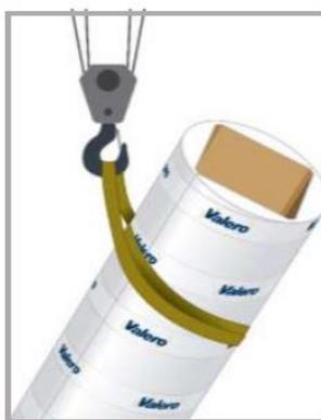
**Il est recommandé d'utiliser des coffrages/ moules respectant les hauteurs maximales de production afin d'obtenir une finition continue et entièrement étanche.**
