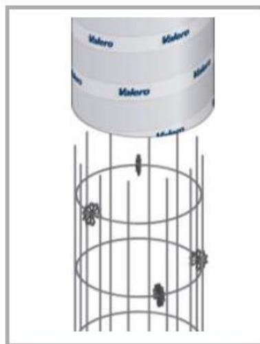
Au moment d'élever le coffrage, il est recommandé d'utiliser une sangle et de la positionner à 1 mètre minimum du bord du coffrage.
