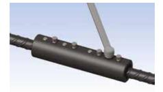
Compléter le serrage des vis de pression à l'aide d'une clé à cliquet ou d'une visseuse. Ne pas utiliser de clé à chocs. Serrer les vis de façon alternée (d'abord une vis sur deux, puis les vis restantes) jusqu'à rupture des têtes.
