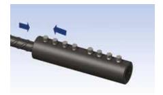
Enfiler le manchon sur l'armature. Celle-ci doit pénétrer jusqu'à mi-chemin du manchon avec une tolérance de ± 6mm. Serrer les vis de pression à la main jusqu'au contact de l'armature. Vérifier l'alignement et faire les corrections nécessaires.
